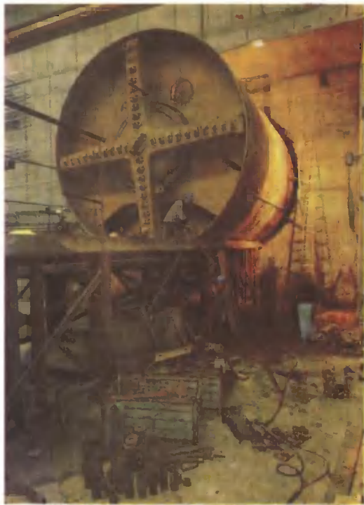
Специальная проходческая машина «Геркулес» в момент появления в южном экспериментальном зале «Геры». За «плечами» «Геркулеса» два года работы под землей и прорытый туннель «Геры».
